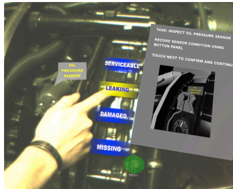
Figuur 17: Augmented reality bij onderhoud ( http://graphics.cs.columbia.edu/projects/armar/ )
